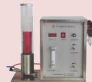
**主要用途:** 用于测定各种形式的纺织品（包括机织、针织、无纺布物等）的燃烧性能，也适用于塑料、橡胶、纸张等的燃烧性能测定。
